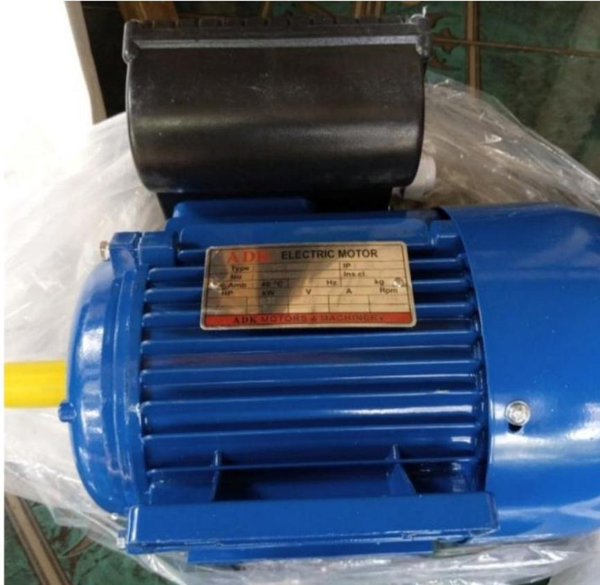
Gambar 3.6 Motor listrik 1 phase 0,5 HP
