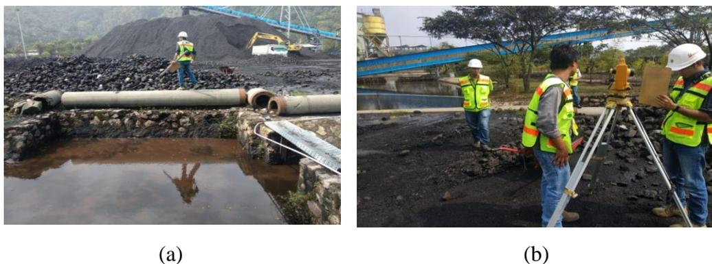
Gambar 20. Kegiatan pengukuran, (a) Pemasangan galah pada saluran drainase *stockpile*, (b) Kalibrasi peralatan pengukuran
