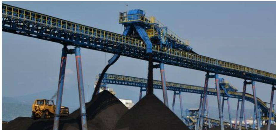
Gambar 8. Curahan batubara dari RCD 3 dan RCD 4 ke *stockpile* .4
