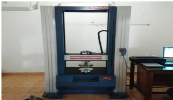
Gambar 2.1. Alat Uji Kuat Tekan (Sumber: Pusat Riset Teknologi Pertambangan-BRIN).
