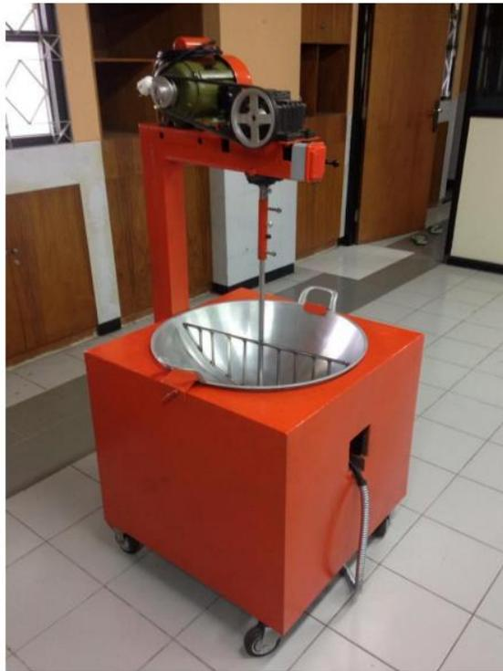
Gambar 17. Alat Pengaduk Dodol Semi Otomatis Ergonomi
