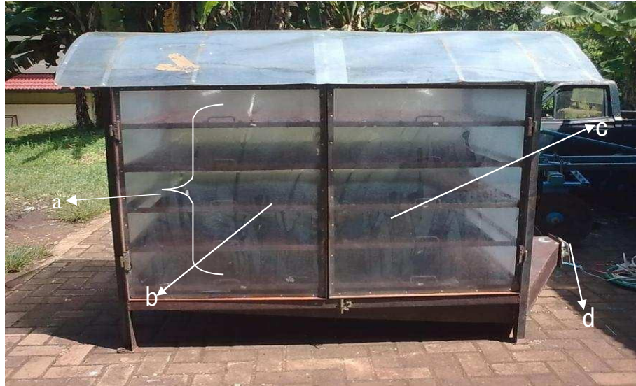
Gambar 2. Alat pengering hybrid tipe rak
