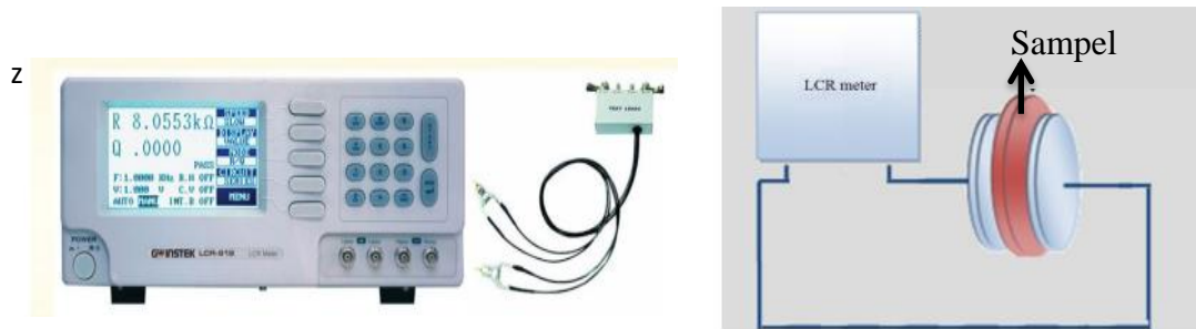
Gambar 2.10 Skema Instrumentasi LCR Meter (Rabih et al. , 2015)
