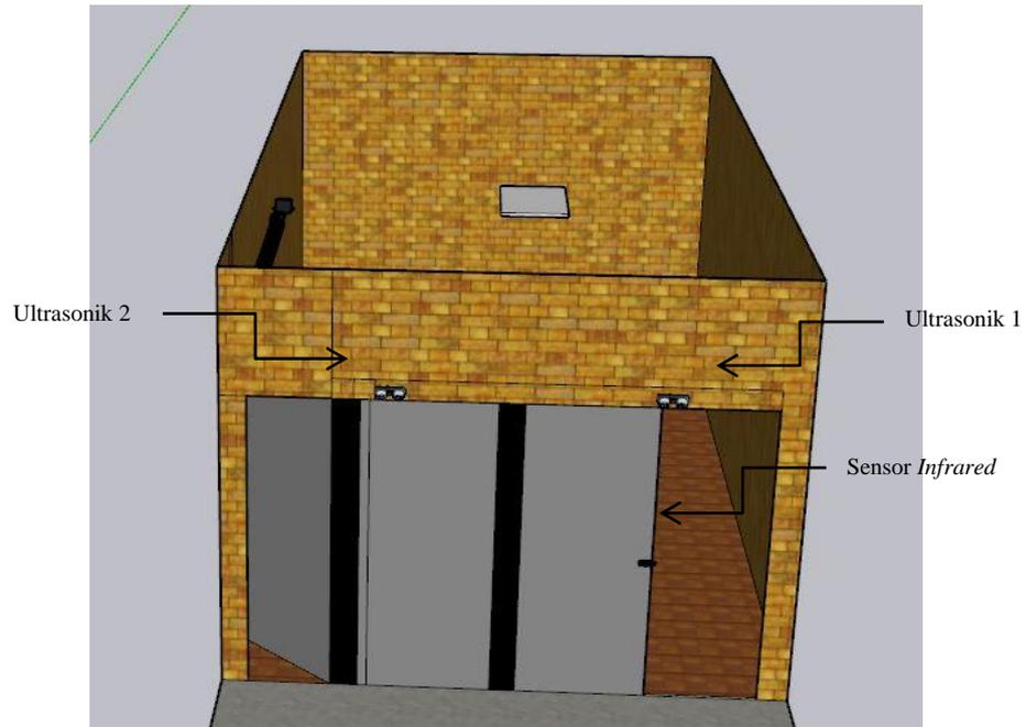
Gambar 3.6 Rancangan gambar garasi otomatis tampak depan
