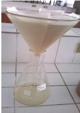
Gambar 13. Hasil Maserasi Disaring dengan Corong Buctner Beserta Kertas Saring dan Ditampung dengan Erlenmeyer .
