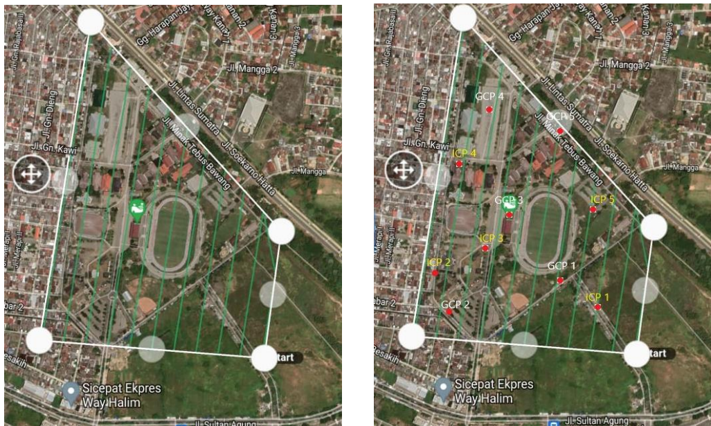
Gambar 7. jalur terbang dan penentuan titik GCP/ICP
