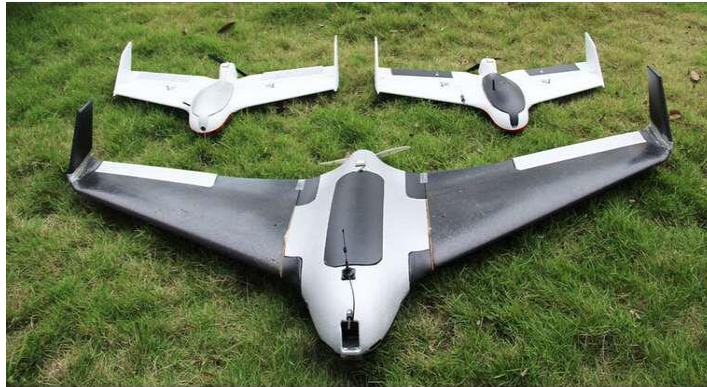
Gambar 2. Contoh Pesawat Fix Wing UAV untuk keperluan pemetaan.
