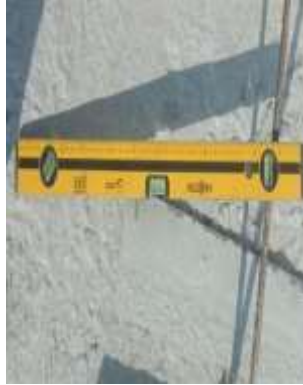
Gambar 3. 20 Waterpass manual Sumber : Dokumentasi lapangan.
