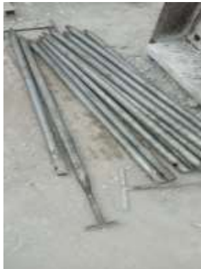
Gambar 3. 13 Pipa Besi Galvanis Sumber : Dokumentasi lapangan.
