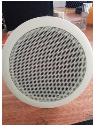
Gambar 3.49. Ceiling Speaker (Sumber : Dokumentasi Lapangan,2021)
