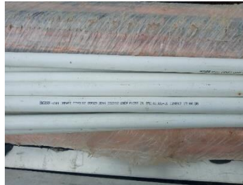
Gambar 3.29. Pipa Conduit (Sumber : Dokumentasi Lapangan,2021)
