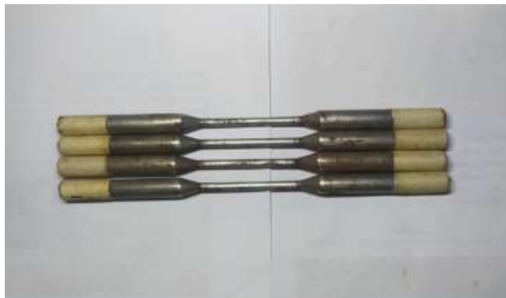
Gambar 3.11 Spesimen uji tarik Baja AISI 1045 berdasarkan ASTM-E8
