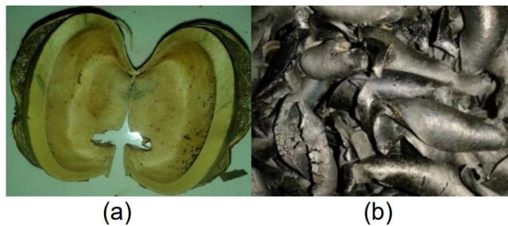
Gambar 1. (a) Cangkang buah karet dan (b) cangkang buah karet setelah karbonisasi (Bangun dkk., 2016).
