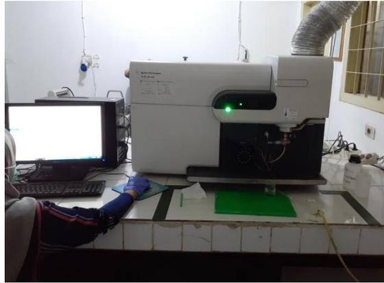
Gambar 14. Rangkaian alat Spektrofotometer Serapan Atom (SSA).
