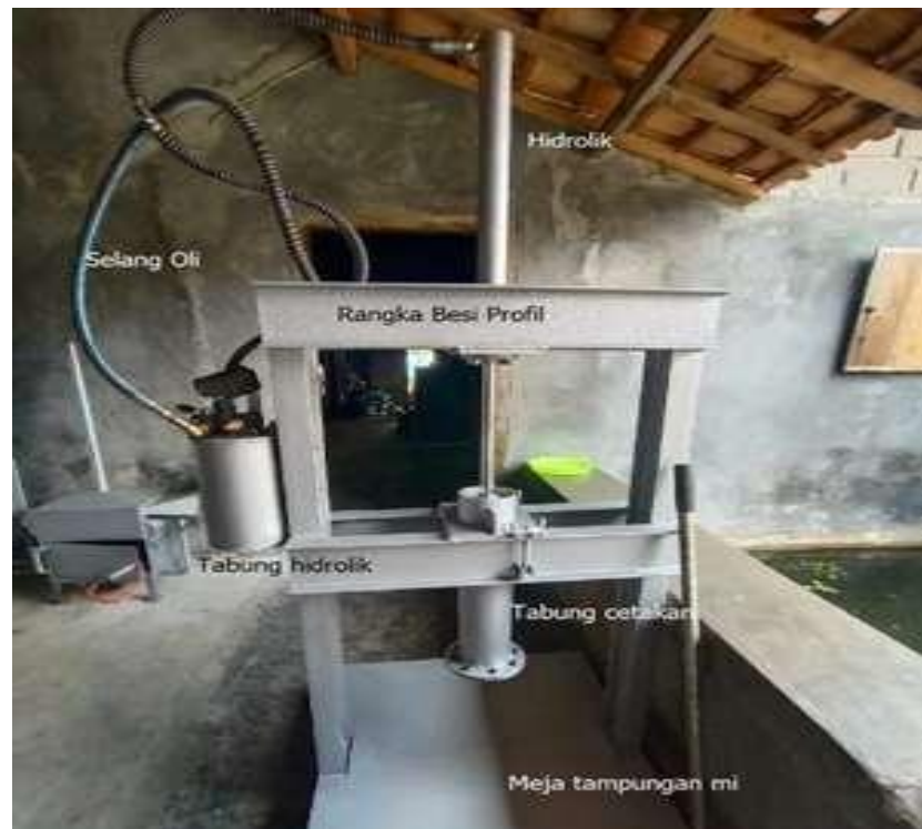
Gambar 9. Mesin pencetak mi aci hidrolik
