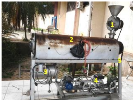
Gambar 3.1 Reaktor torefaksi kontinu tipe tubular dengan pemanas selimut oli.
