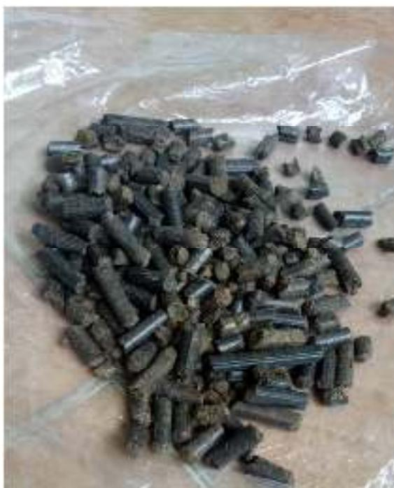
Gambar 11. Proses Torefaksi Pelet dengan Suhu 240 °C
