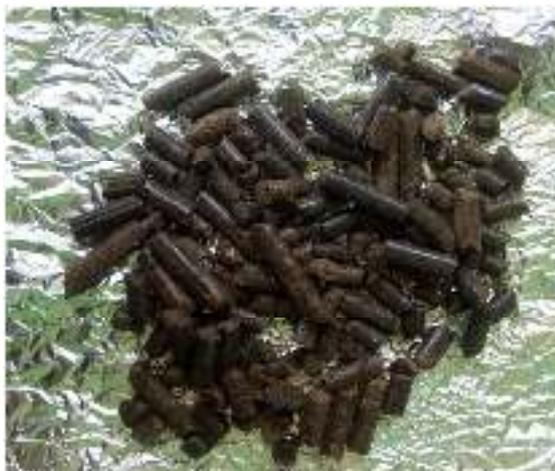
Gambar 10. Proses Torefaksi Pelet dengan Suhu 220°C
