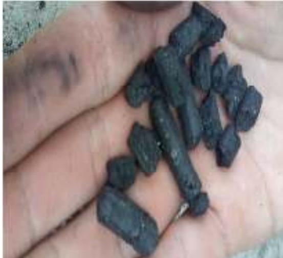
Gambar 13. Pelet Terbakar pada Suhu 280°C dengan jelas
