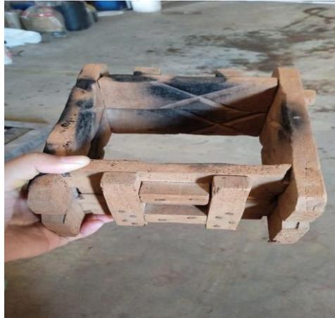
Gambar 3.9.Rangka Cetak
