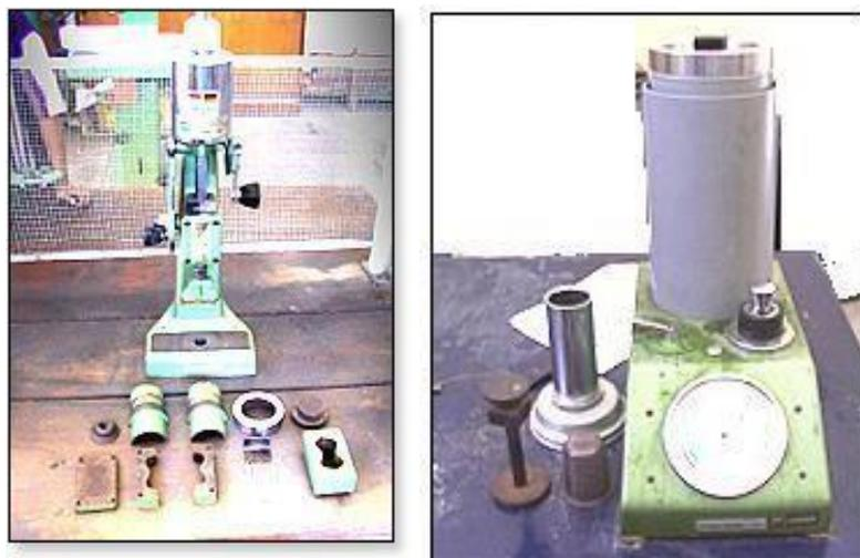
Gambar 2.11. Pemadat pasir standar Gambar 12. Alat uji permeabilitas
