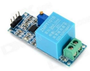
Gambar 2. 14 Sensor tegangan AC ZMPT101B.
