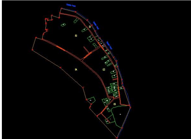
Gambar 3.8. Skema Pengukuran Bidang Tanah
