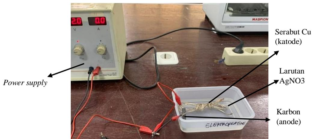
**Gambar 3.4.** Elektroplating Ag pada Cu
