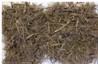
Gambar 3. Ampas tebu ( Bagasse ) limbah sisa penggilingan
