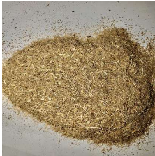
Gambar 6. Baggasse dengan ukuran partikel halus (ukuran 12 mesh)
