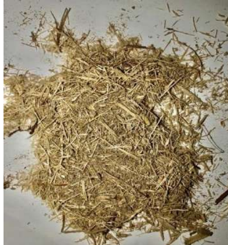
Gambar 8. Baggasse dengan ukuran partikel kasar (ukuran 8 mseh)
