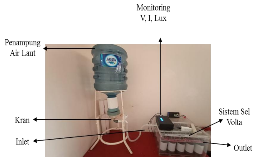
Gambar 2.3 Realisasi sistem sel volta (Andi, 2020)
