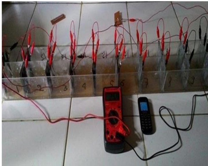
Gambar 2.1 Pengambilan Data Karakteristik Elektrik Air Laut (Pauzi dkk., 2016)
