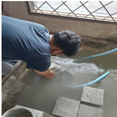
Gambar 3.20. Tahap curing pada benda uji beton kubus.
