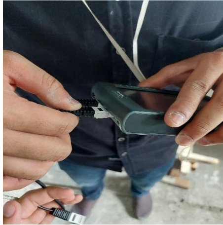
Gambar 3.26. Menghubungkan sensor dengan data logger sesuai sumbu.
