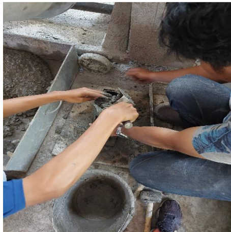
Gambar 3.11. Tuangkan beton segar ke dalam kerucut abrams .
