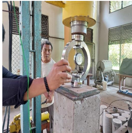
Gambar 3.30. Atur proving ring agar berada di tengah-tengah tiang.
