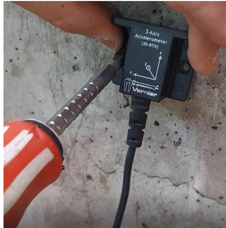
Gambar 3.24. Angkurkan accelerometer dengan obeng dan baut.
