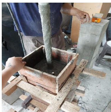
Gambar 3.16. Memadatkan beton segar dengan vibrator .
