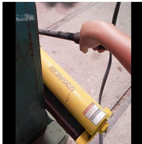
Gambar 3.31. Pemberian beban menggunakan loading frame .
