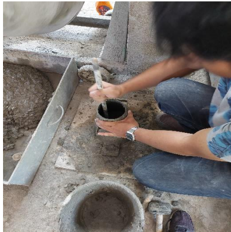
Gambar 3.12. Tumbuk beton segar sebanyak 25 kali dengan tongkat besi.
