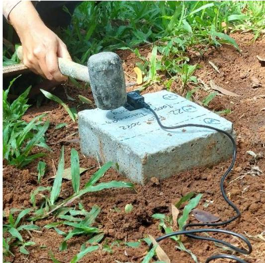
Gambar 3.16. Mengetuk benda uji setelah ditimbun.
