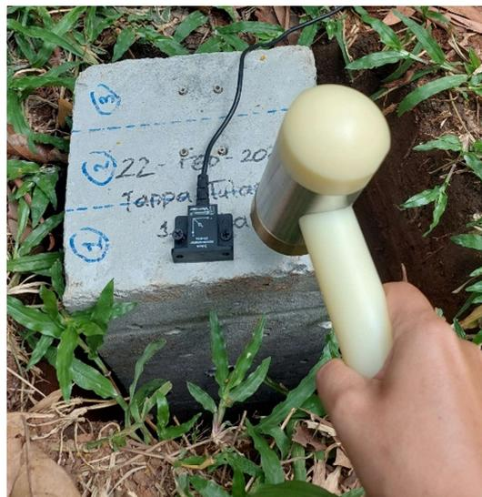
Gambar 3.15. Mengetuk benda uji sebelum ditimbun.
