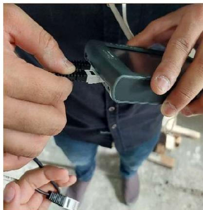
Gambar 3.8. Menghubungkan *3-axis accelerometer* ke *labquest 2*.
