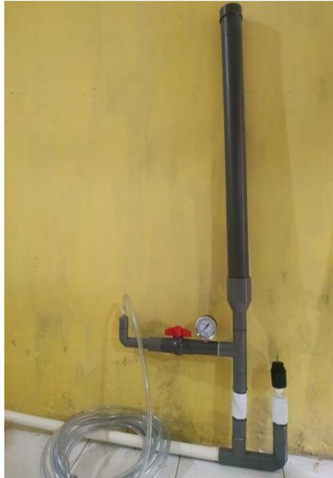
Gambar 9. Pompa hidram.
