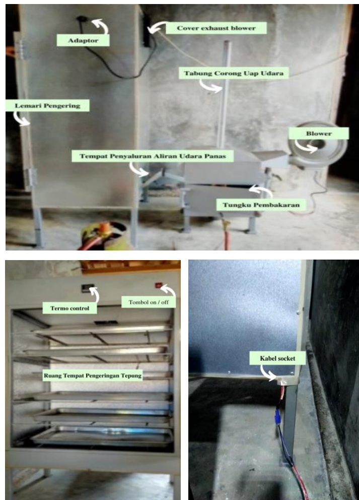
Gambar 12. Seperangkat alat pengering tepung aci singkong.
