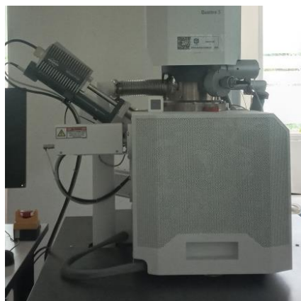
Gambar 2.5 Perangkat SEM. Sumber: (dokumen pribadi )
