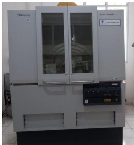
Gambar 2.4 Perangkat XRD. Sumber: (dokumen pribadi)
