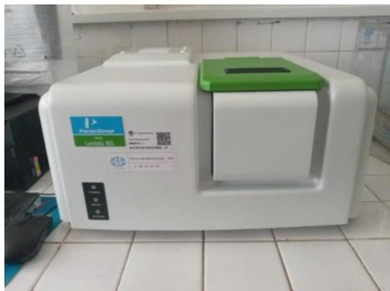
**Gambar 2.11** Alat spektrofotometri UV-Vis (Sumber: dokumen pribadi)
