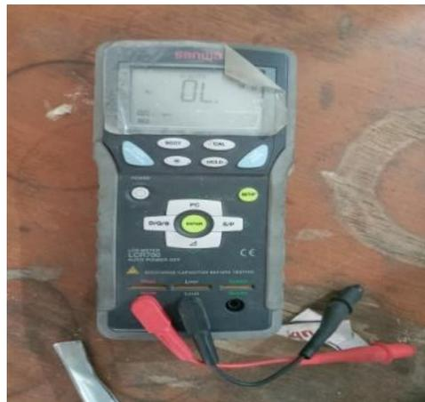
**Gambar 2.4** Alat LCR meter (Sumber: dokumen pribadi)
