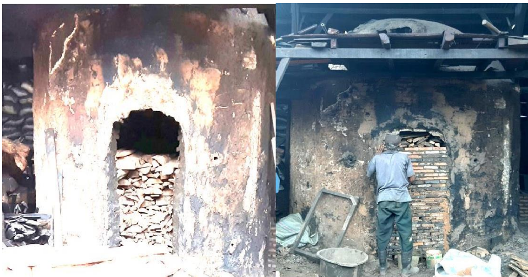
Gambar 2. Bentuk tungku kubah pembuatan arang hayati.
