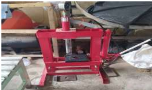
Gambar 1. Alat Pres Hidrolik
