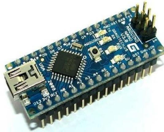
**Gambar 2.12** Arduino nano (Muchtar dan Asep, 2017)
