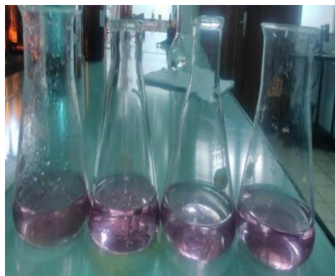
Gambar 11. Analisis N Total (a) Larutan contoh tanah sebelum dititrasi, (b). Larutan contoh tanah setelah dititrasi
