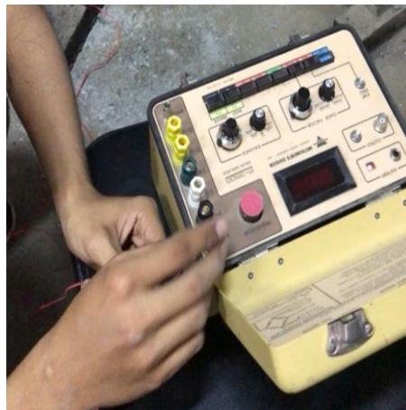
Gambar 3.15. Menghubungkan kabel strain gauge ke indicator strain
