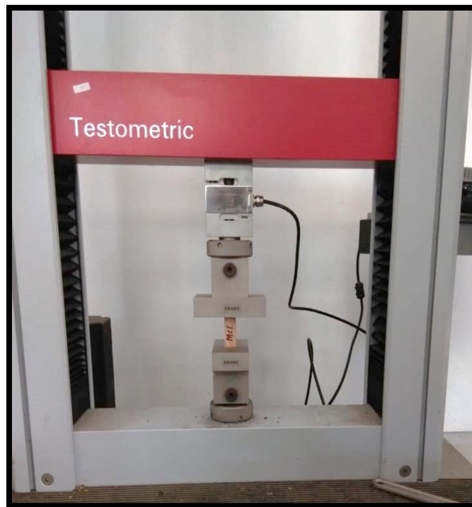
Gambar 7. Pengujian tekan kayu
