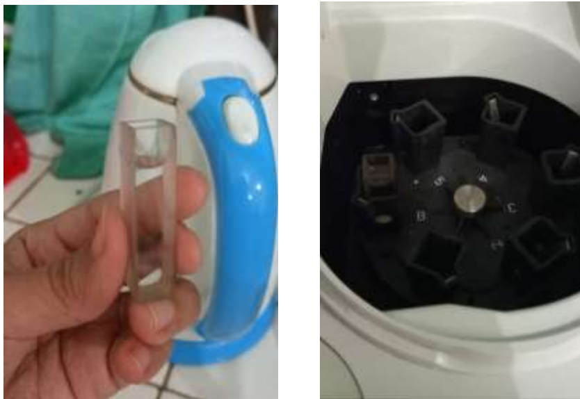
Gambar 21. Proses pengambilan spektra menggunakan UV-vis Spektroskopi.
