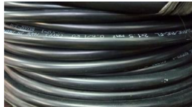
Gambar 3.23. Kabel NYY (Sumber : Dokumentasi Lapangan,2021)
