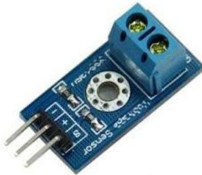
**Gambar 2.4** Sensor tegangan (Winata dkk., 2016).
