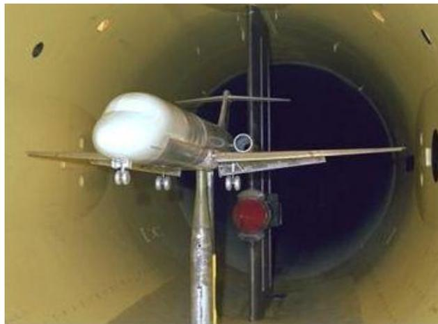
**Gambar 31.** Pengujian pada *wind tunnel*. [Wikipedia]
