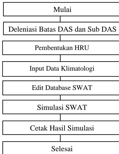
Gambar 2 Diagram Alir Proses Pembuatan Peta DAS.
