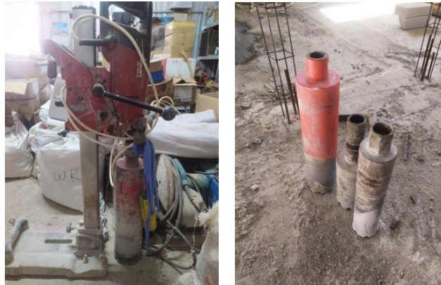
Gambar 3. 5 Alat Coring Beton Sumber: Dokumentasi Lapangan
