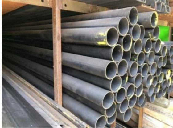
Gambar 3. 36 Pipa Black Steel Sumber: Dokumentasi lapangan
