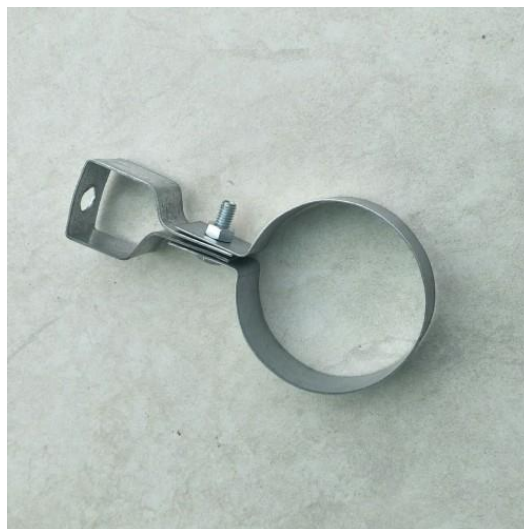
Gambar 3. 16 Hanger clamp Sumber: Dokumentasi Lapangan
