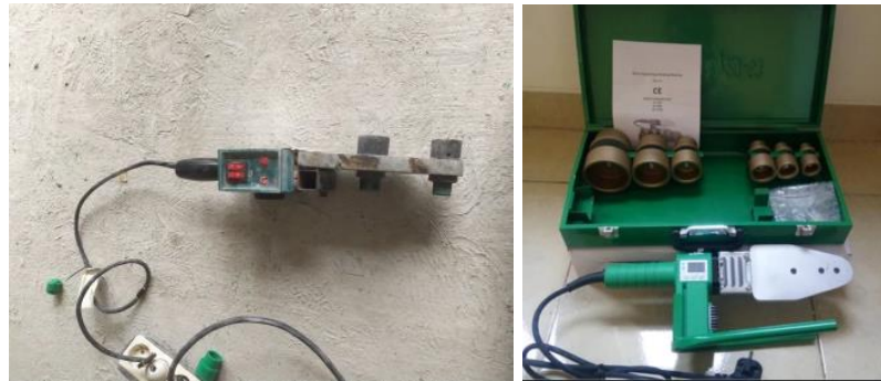
Gambar 3. 7 Mesin las pipa PPR Sumber: Dokumentasi Lapangan
