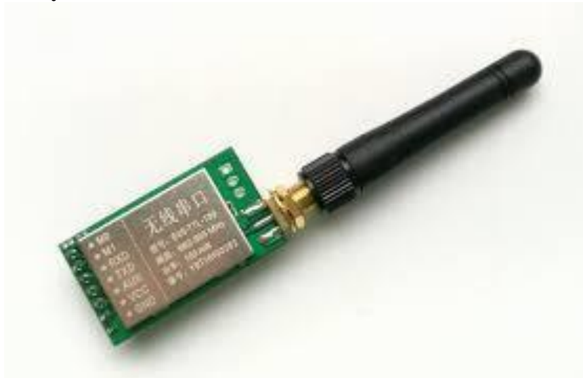
Gambar 2.11 LoRa Ebyte E32 [Sumber: LoRa ebyte E32, https://www.ebyte.com ]
