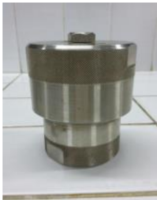
Gambar 13. Alat sintesis secara SAC atau autoklaf (Yulianti, 2017)
