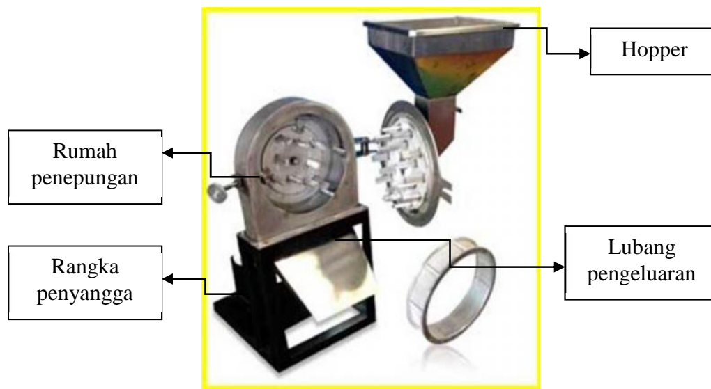
Gambar 9. Komponen penyusun disc mill Sumber: Efendi dan Suhartono, 2019
