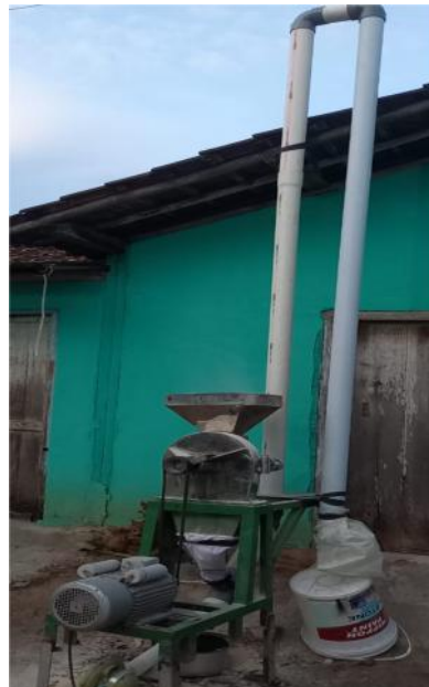
Gambar 11. Mesin produksi glukomanan secara mekanis dengan disc mill .
