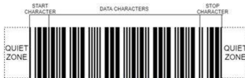
Gambar 2.1. Struktur susunan Barcode
