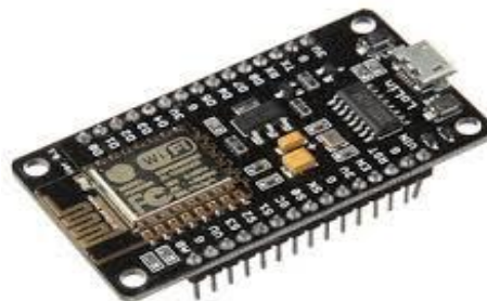
Gambar 2.7. NodeMCU ESP8266 V3
