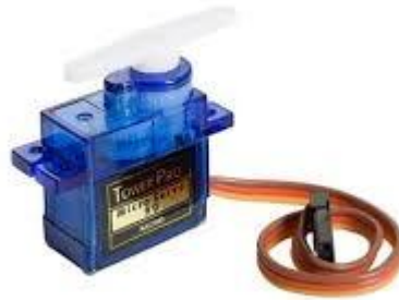
Gambar 2.4. Motor Servo DC SG90 90°
