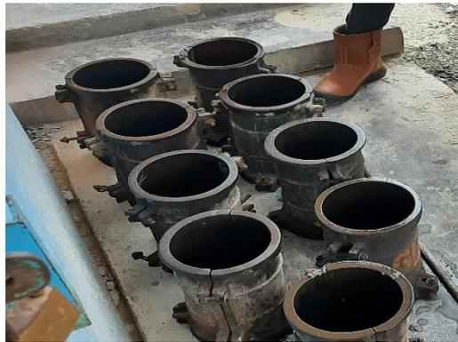
**Gambar 3.31.** Cetakan Silinder
