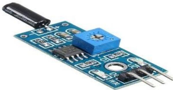
Gambar 3.10 sensor vibrasi sw42
