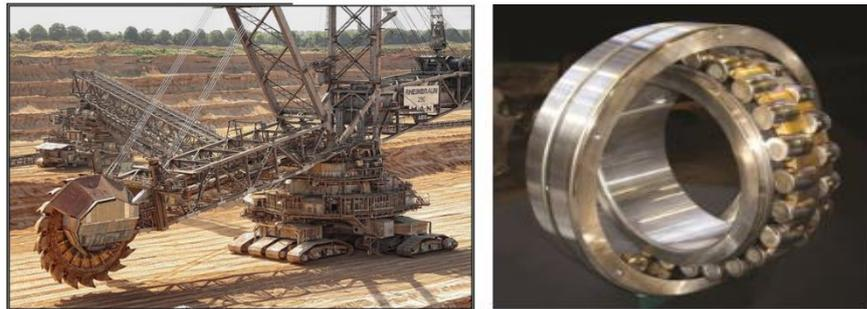
Gambar 2.3 Bucket wheel excavator dan jenis *bearing* yang digunakan pada excavator
