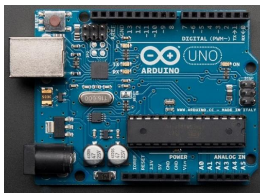
Gambar 2. 2 Arduino UNO R3 Berbasis Atmega 328P
