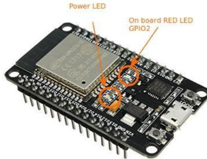
Gambar 2.4. Konfigurasi NodeMCU ESP32.
