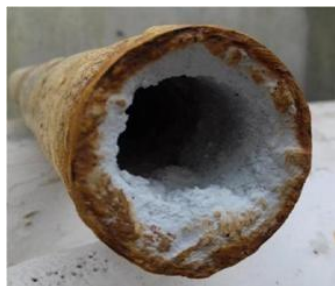
Gambar 1. Endapan kerak kalsium sulfat dalam pipa (Crabtree et al., 1999)
